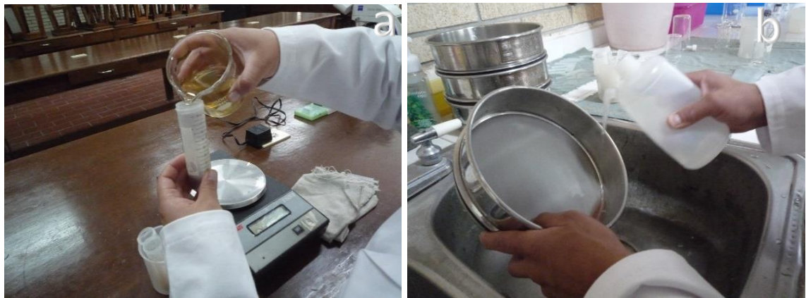
Figura 11. Aplicación de solución sacarosa para diluir la pastilla de caolinita para centrifugarse a 3500 rpm (a) y lavado de nematodos de la solución sacarosa para vaciar la muestra en frascos de 20 ml (b).
