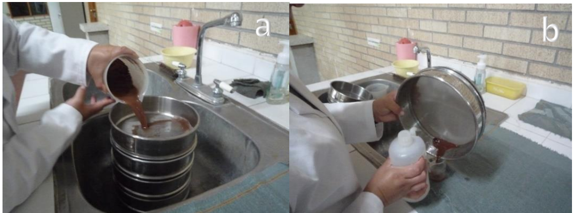
Figura 9. Uso de tamices de 60, 100, 240 y 400 mallas para obtener el sobrenadante con nematodos flotando (a) y uso de la piseta para extraer los nematodos presentes en el tamiz de 400 mallas (b).
