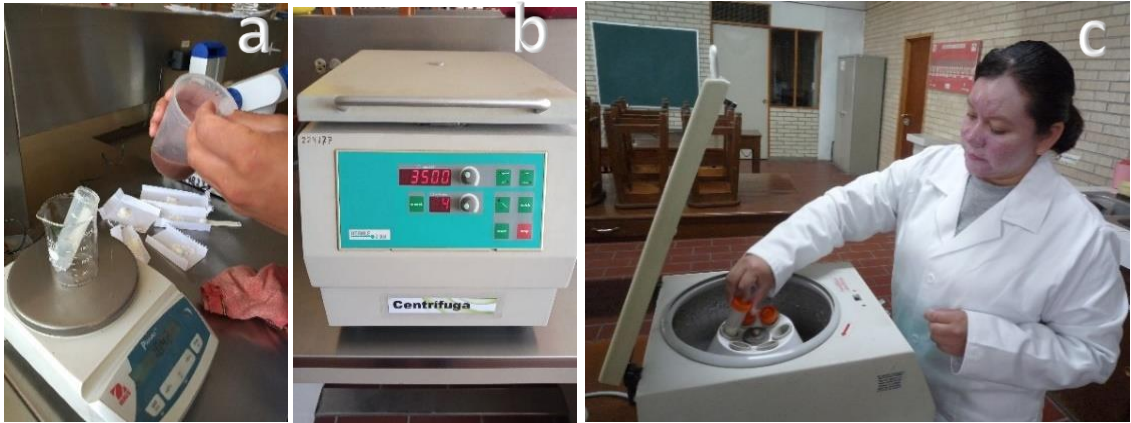
Figura 10. Llenado y calibración de los tubos para centrifugar a 3500 rpm (a y b) y colocación de tubos con caolinita para centrifugarse a 3500 rpm (c).
