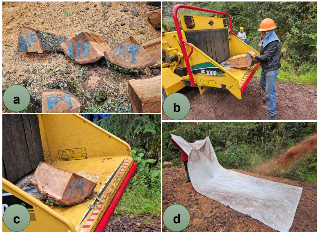
Figura 8. Réplica del segundo ensayo: a) troza seccionada (A9–A10 para astillado; B9–B10 como testigo); b) y c) alimentación; d) recolección de astilla.
