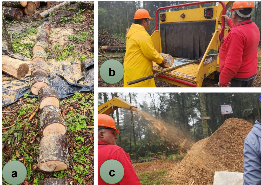
Figura 6. Proceso de astillado del primer ensayo: a) troza seccionada; b) alimentación; c) salida de astilla.
