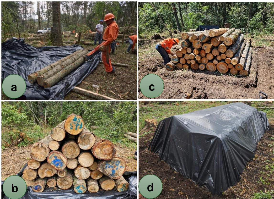
Figura 14. Comparación del armado de pila: a) colocación de plástico base previo al armado; b) pila con sello completo lista para cubrirse (izquierda); c) pila con sello de tierra en construcción (zanja perimetral); d) pila con sello incompleto o sellado con tierra (derecha).
