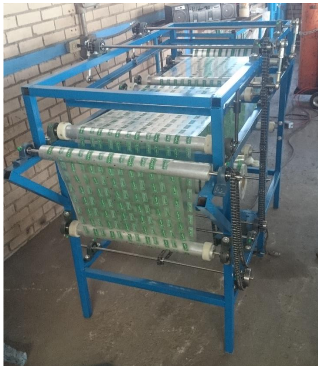
Figura 7-1.-máquina micro perforadora, sistema de alimentación de polipropileno
