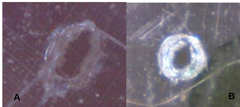
Figura 8-11.- orificio con tensión de la película de (A) 60 N y (B) 80N.
