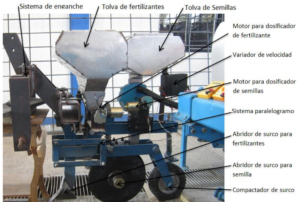
Figura 60. Ensamblaje General de los dosificadores.
