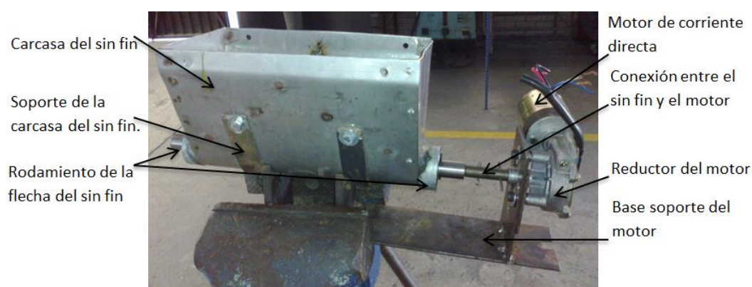
Figura 59. Ensamblaje General del dosificador de fertilizantes.
