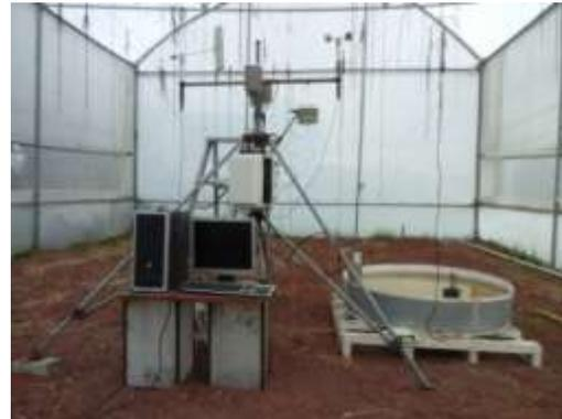
Figura 5.2. Estación automática al interior del invernadero.
