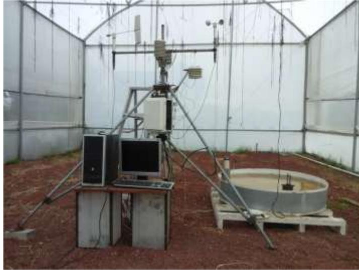
Figura 4.2. Estación automática al interior del invernadero.
