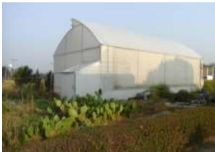
Figura 6.1. Invernadero con un volumen de aire de 550 m<sup>3</sup> y área útil de 105 m<sup>2</sup>.
