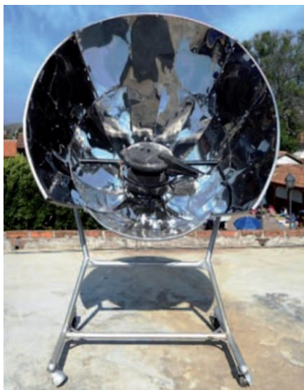
Figura 5. Cocina solar Jorhejpataranskua, vista frontal. Fuente: Tomada de López, 2014.
