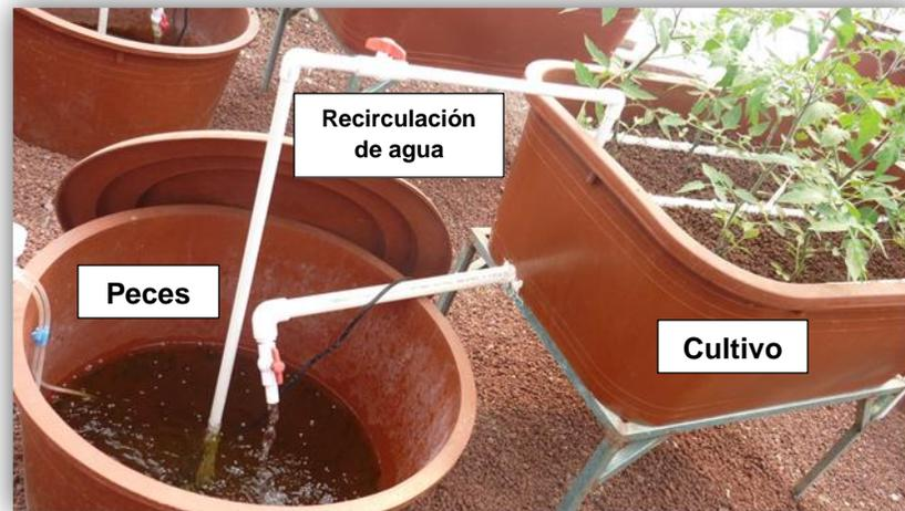
Figura 5. Componentes del sistema acuapónico en el área experimental (Elaboración propia).
