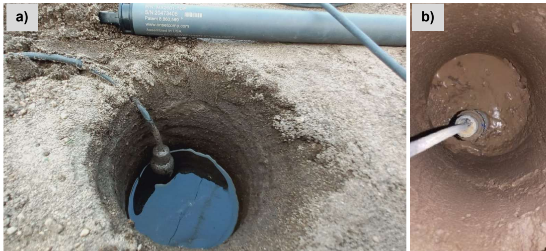
Figura 3. Medición de descenso del agua en pozo barrenado con sonda HOBO en el modelo físico experimental para la obtención de la conductividad hidráulica saturada: a) suelo homogéneo, b) suelo heterogéneo.
