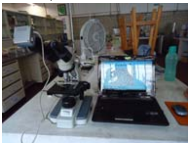
Obtención de fotos con cámara adaptada a microscopio
