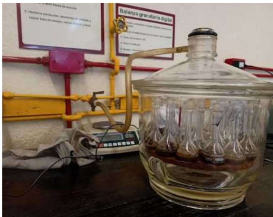
Ilustración 27. Determinación de la Densidad Real por el método del Pícnómetro.
