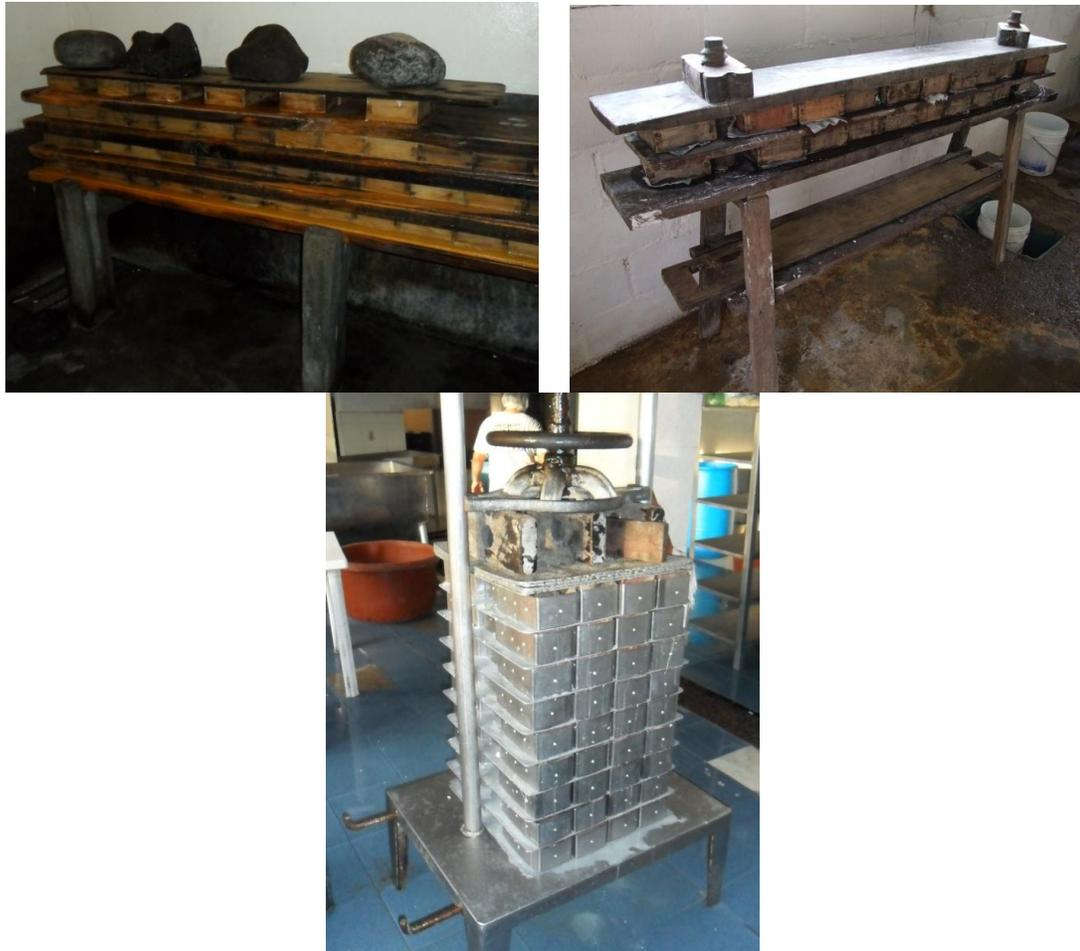
Figura 20. Prensas utilizadas en el proceso de elaboración del Queso Crema, madera y piedras (arriba izquierda), de madera con tornillo (arriba derecha) y de acero inoxidable (abajo).
