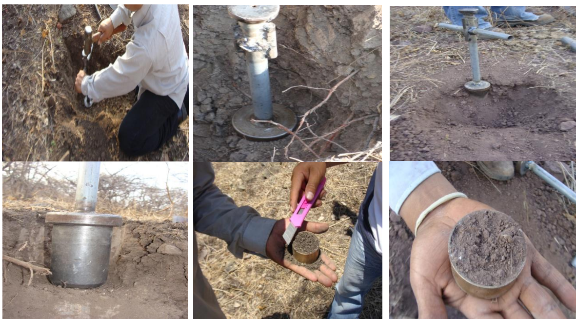
Figura 9. Procedimiento para la obtención de muestras de suelo con una barrena de muestras inalteradas.
