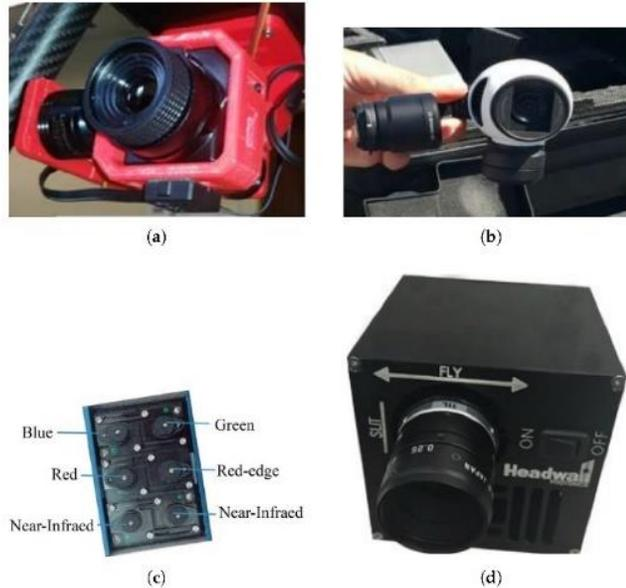
**Figura 2.** Sensores usados en los RPAS para la agricultura inteligente: a) térmico, b) RGB, c) multiespectral, d) hiperespectral. Fuente: (Tsouros et al., 2019)
