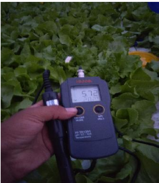
Figura 13. Medición de la variable pH en la solución nutritiva del sistema de producción de lechuga hidropónica con la instrumentación HANNA.
