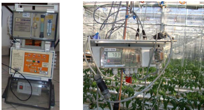
Figura 3.4) Sensores empleados para monitorear las condiciones del cultivo. Izquierda, PTM-48M; derecha, PTF-30.
