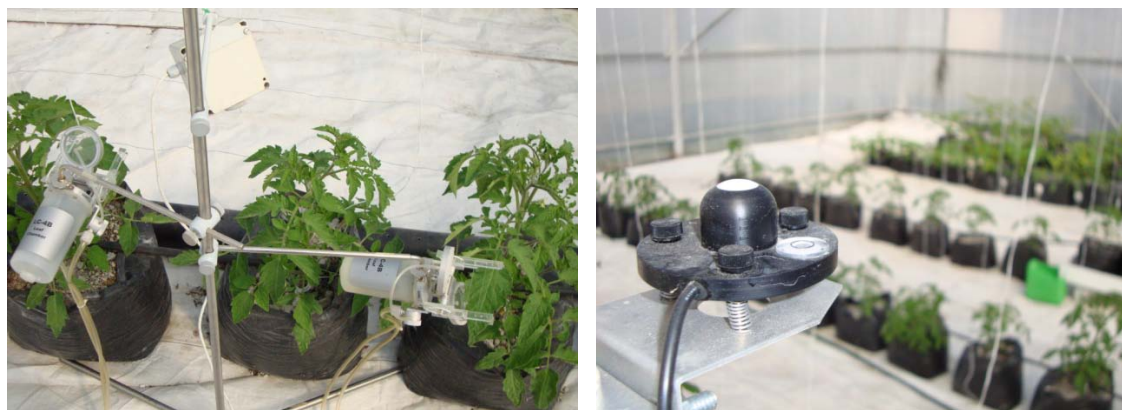
Figura 3.2) Sensores instalados en el experimento. Izquierda, 2 cámaras de monitoreo y sensor ventilado para temperatura y humedad relativa del PTM-48M. Derecha, sensor de radiación PAR.
