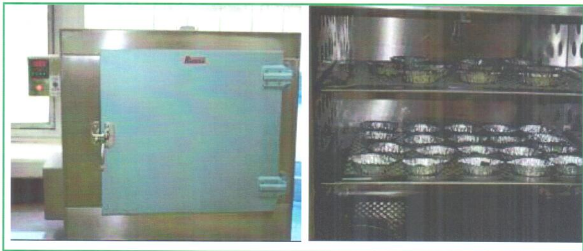
Figura 7. Secado de muestras para peso anhidro
