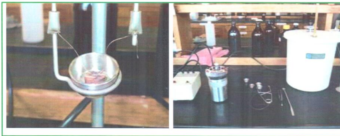
Figura 8. Proceso de combustión de muestras para poder calorífico
