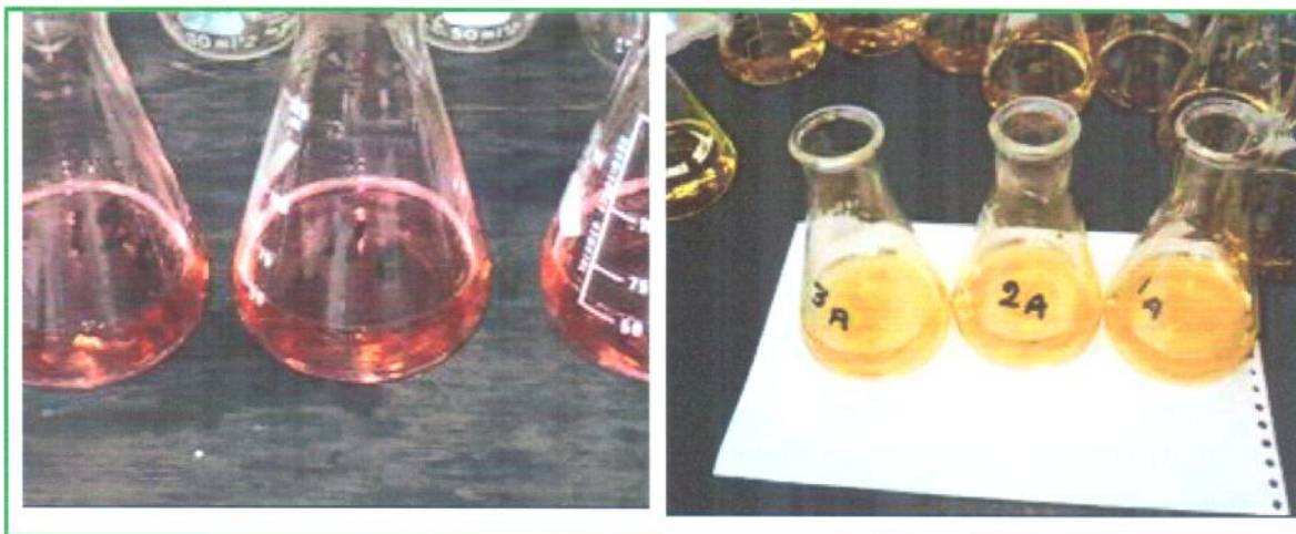
Figura 9. Titulación por ácido nítrico de lavado después de cada combustión
