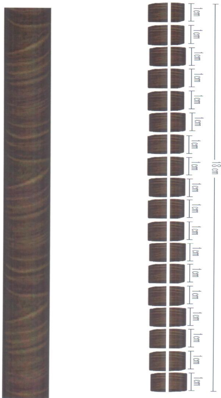
Figura 4. Cilindro obtenido de los árboles y esquema de seccionado para los diferentes procedimientos en el estudio.
