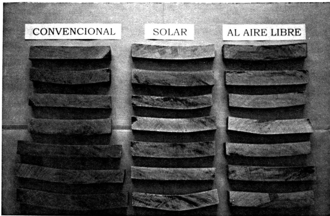
Fig. 12. Muestras usadas para evaluar la presencia de apanamiento en los tres sistemas de secado.
