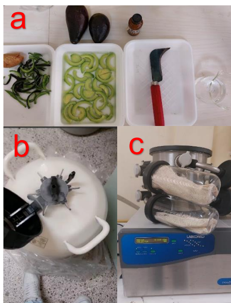
Figura 3 Proceso de liofilización de pulpa de aguacate criollo: a) corte y despulpe, b) congelación y c) liofilización.
