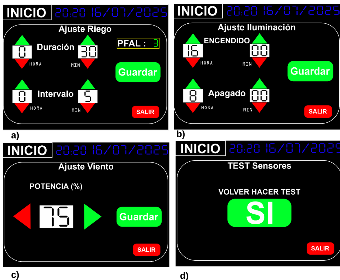
Figura 4.21. Pantallas de ajustes individuales a) Ajuste del Riego, b) Ajuste del Periodo de luz, c) Ajuste de la potencia de los ventiladores y d) Opción de volver a hacer el Test
