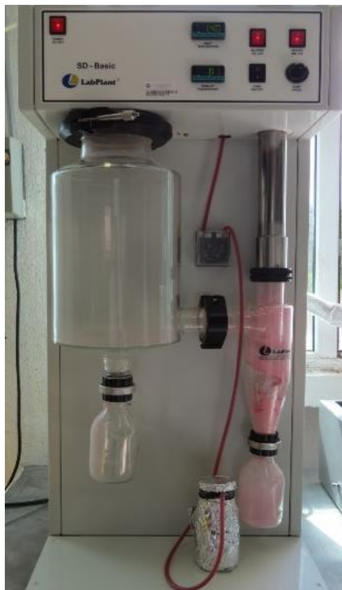
Figura 10. Fotografía del equipo utilizado en la obtención de microcápsulas de betalaínas.
