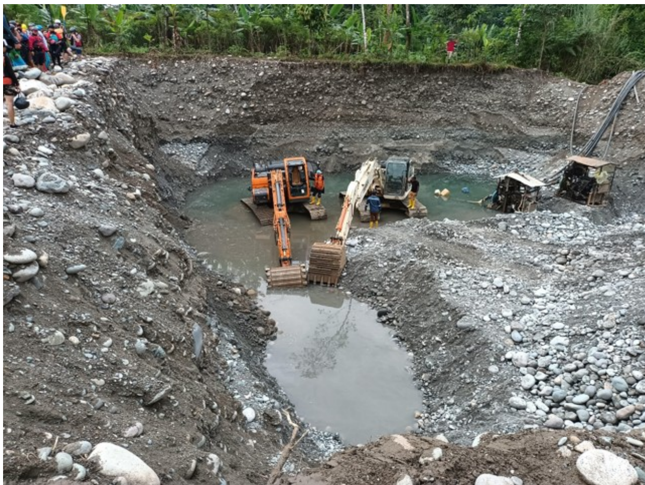
Imagen 20. Explotación minería ilegal cerca del río Jatunyaku / retroescavadoras y motores para succión de arena.
