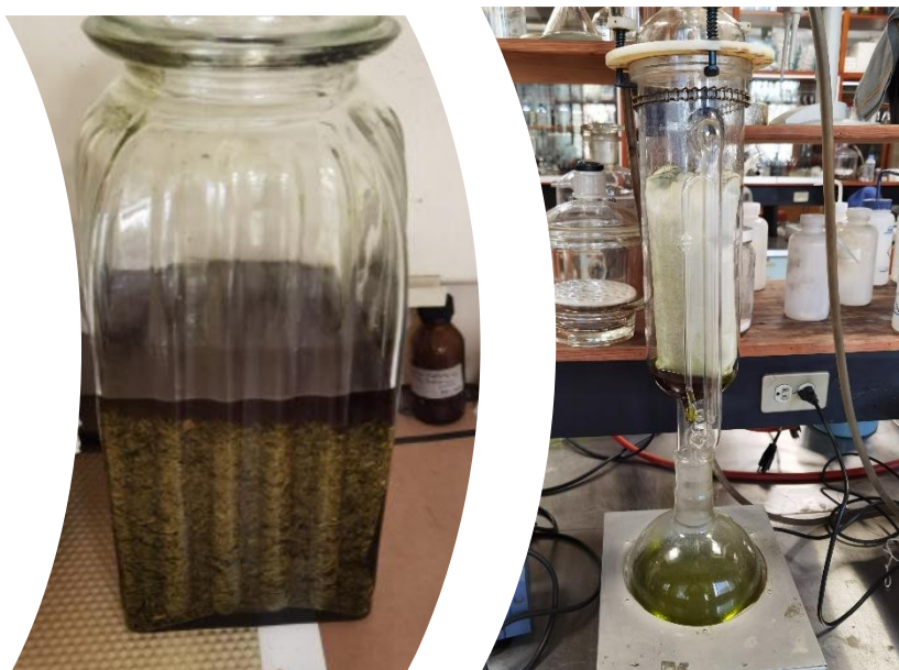
Figura 13. Extracción de compuestos orgánicos de Heimia salicifolia en soxhlet y macerado.
