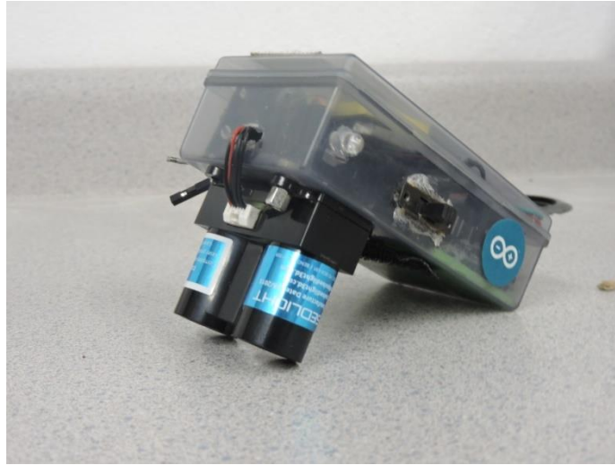
Figura 23 Prototipo del sistema LIDAR desarrollado
