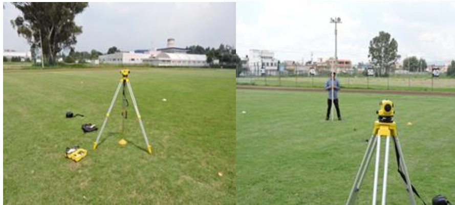
Figura 36 Levantamiento de curvas de nivel
