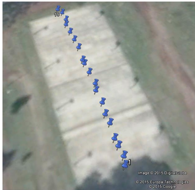
Figura 28 Trayectoria formada por lecturas del sensor GPS u-Blox Neo 6m
