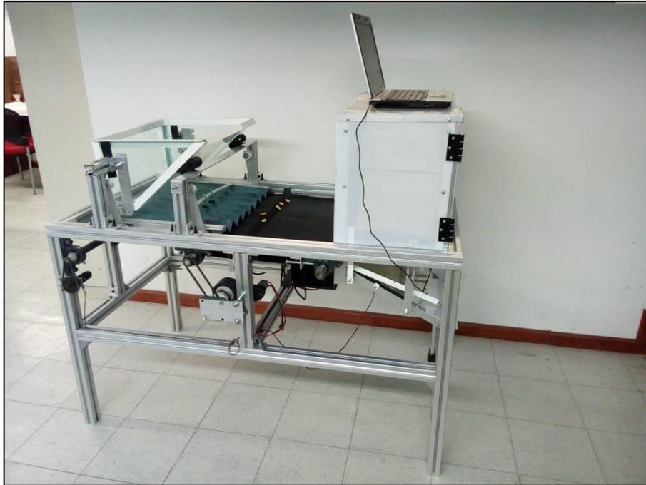
Figura 4.1. Imagen del equipo de clasificación automática mediante visión artificial para granos de haba
