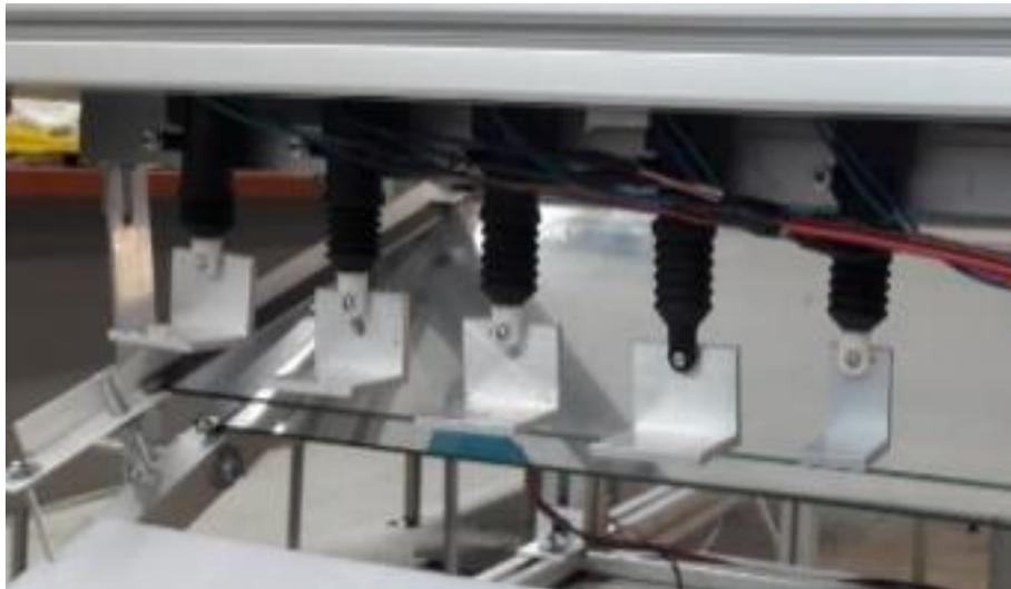
Figura 4.8. Actuadores ubicados en la parte final de la rampa de frenado.
