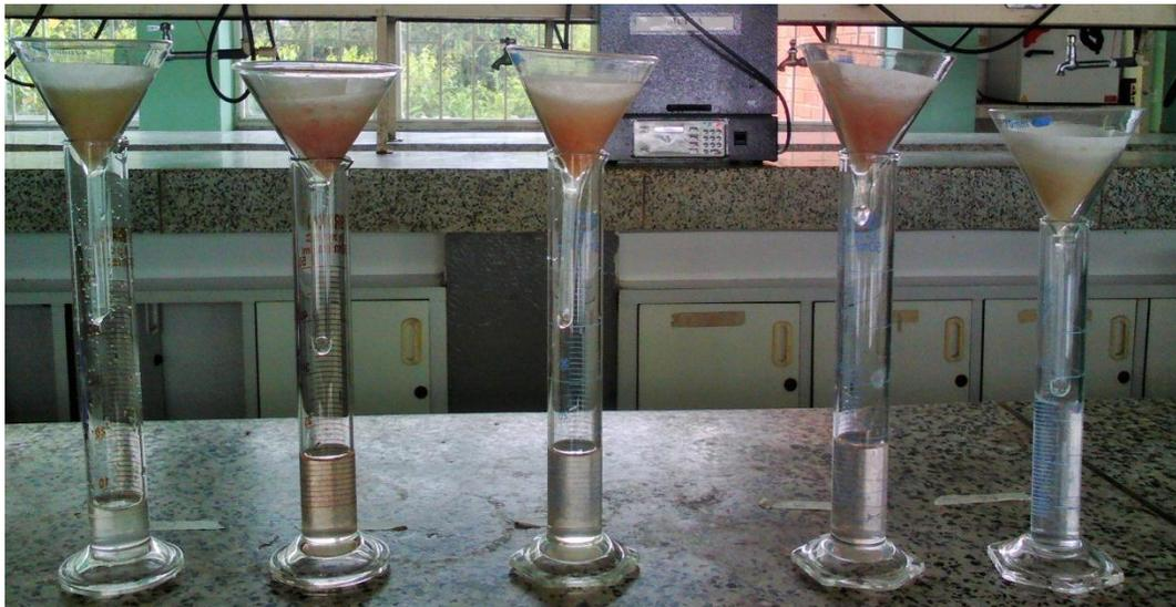
**Figura 9.** Medición del volumen final de los polvos de acetona.
