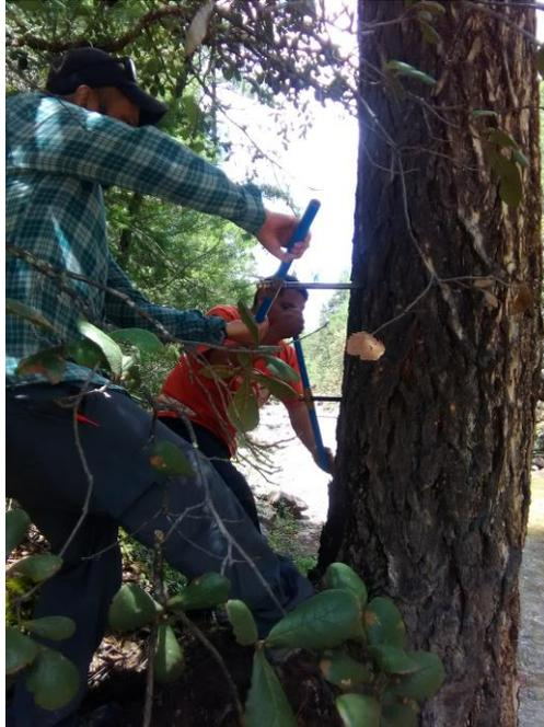
**Figura 18.** Muestreo de *P. menziesii* con taladro de Pressler.
