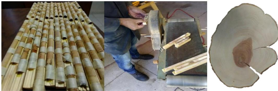
**Figura 5.** Montado y pulido de muestras.
