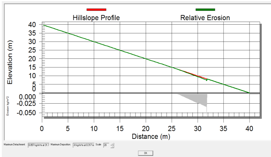
Figura 20. Erosión en perfil de ladera No. 3.
