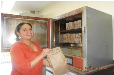
Figura 7. Estimación de carbono en el estrato herbáceo por diferencia de pesos. a) Ubicación de subparcela o subunidad de muestreo para estrato herbáceo de 1x1m. b) se registró el peso total fresco de la muestra compuesta y el peso húmedo de la submuestra c) secado d) registro del peso seco.
