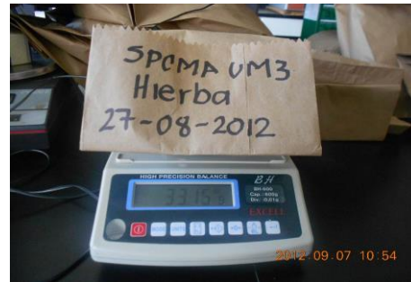
Figura 7. Estimación de carbono en el estrato herbáceo por diferencia de pesos. a) Ubicación de subparcela o subunidad de muestreo para estrato herbáceo de 1x1m. b) se registró el peso total fresco de la muestra compuesta y el peso húmedo de la submuestra c) secado d) registro del peso seco.
