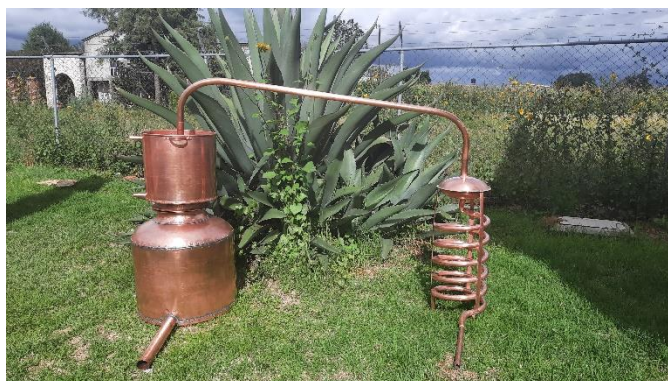
Figura 8. Equipo de destilación fabricado en cobre para elaborar mezcal artesanal.
