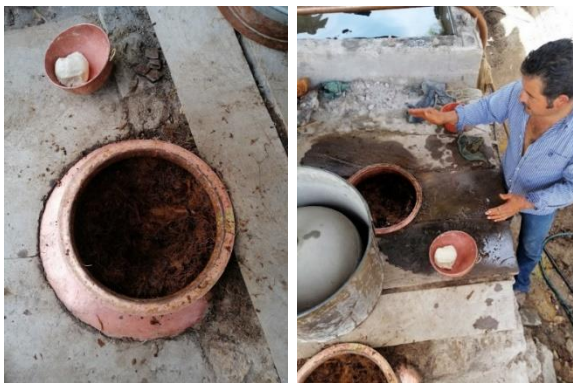
Figura 9. Preparación del material para la destilación: Alambique de cobre con mosto y guarape (Izquierda), Colocación de montera en la olla de destilación empleando masa de maíz como agente de sellado (Derecha).
