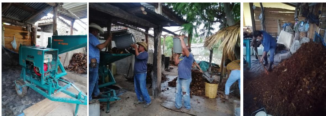
Figura 6. Molienda de maguey con desfibradora: Hebradora de agave (Izquierda), Llenado de la máquina (Centro), agave desfibrado (Derecha).
