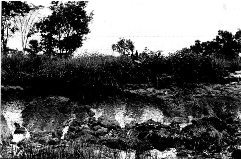
**Figura 9 Perfil del suelo de la zona de estudio, mediante corte por construcción de una carretera.**
