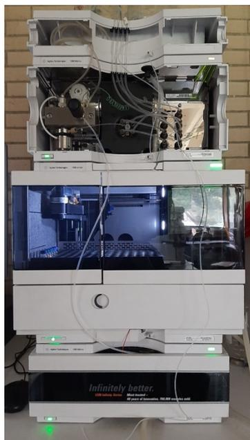
**Figura 7.** Equipo de cromatografía líquida de alta resolución.
