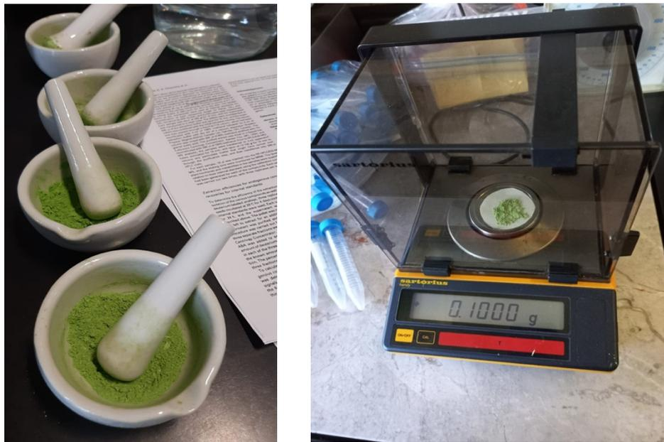
**Figura 5.** Maceración de muestras en mortero (izquierda) pesado de muestras en balanza electro analítica (derecha).
