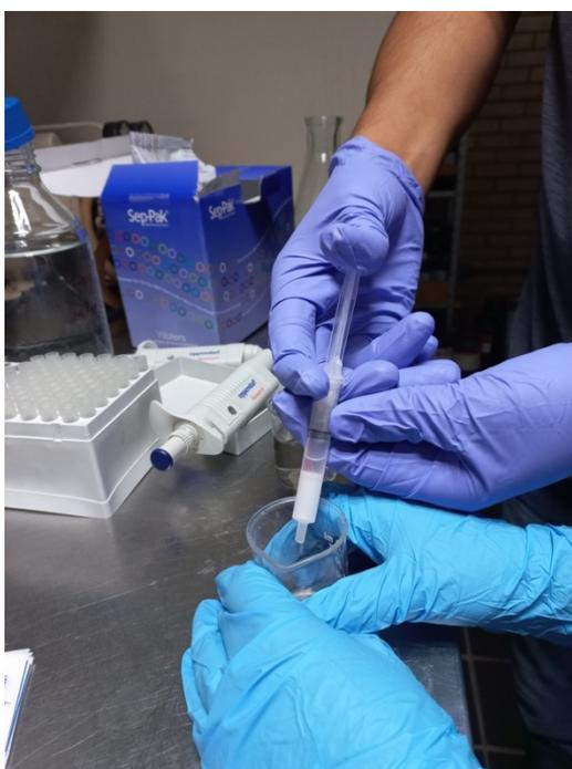
**Figura 6.** Activación de columnas (filtros).
