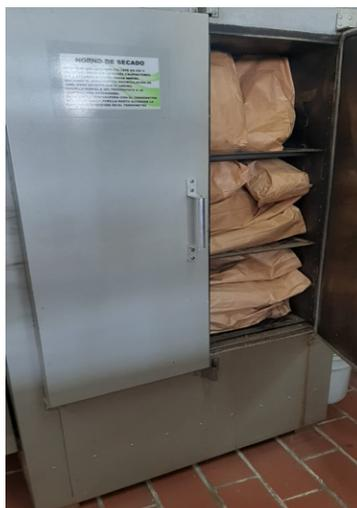
**Figura 2.** Horno de secado con aire circulante.
