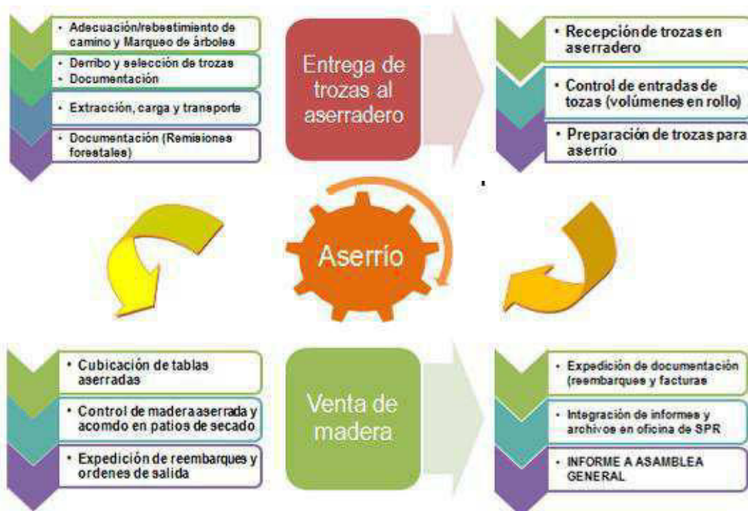
Figura 2. Diagrama de flujo para la producción de madera en rollo y aserrada.
