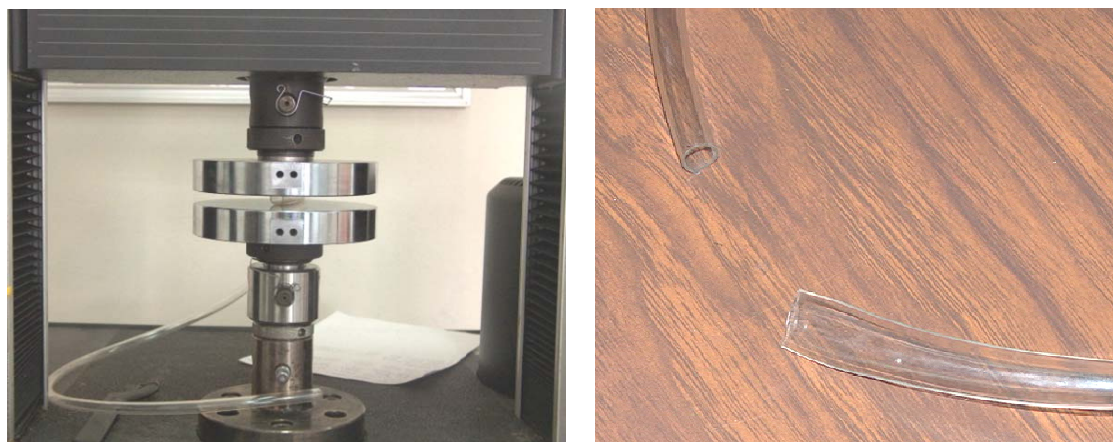
Figura 3.14 Pruebas de compresión para manguera cristal PVC hidrocarburos usando la máquina INSTRON 4469
