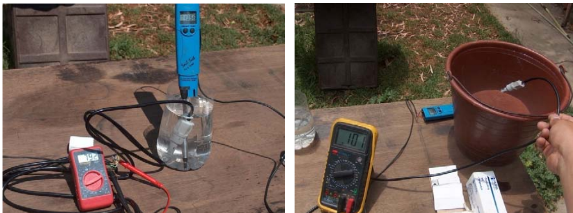
Figura 3.25 Evaluación del sensor de C.E.
