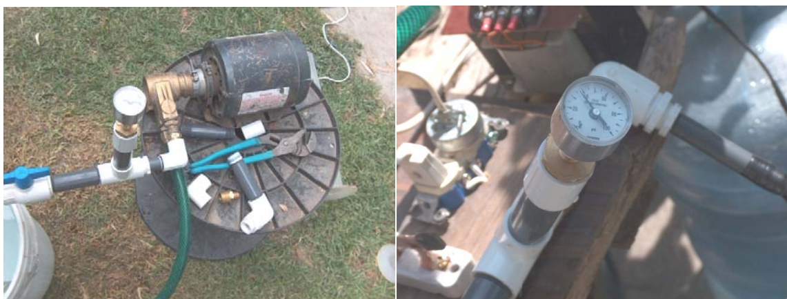
Figura 3.8 Instalación para la prueba de la bomba de paletas rotatorias.
