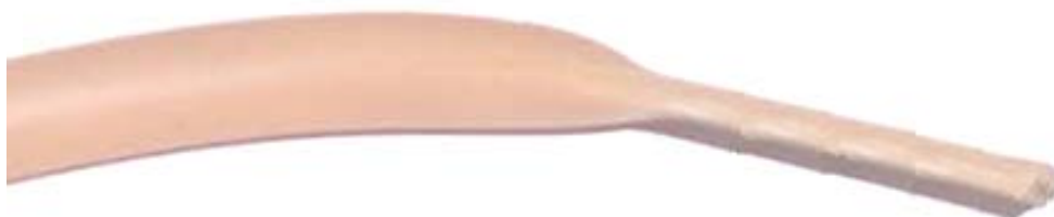
Figura 4.6 Apariencia de la manguera de látex al sacarla de la carcasa de la bomba peristáltica.
