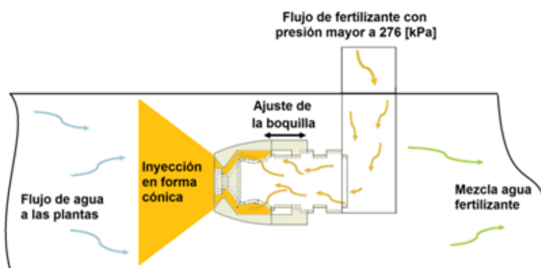
Figura 3.6 Operación del inyector
