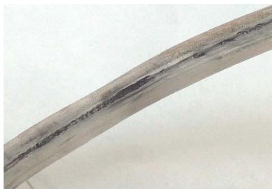
Figura 4.4 Daños ocasionados a la manguera de cristal PVC para hidrocarburos
