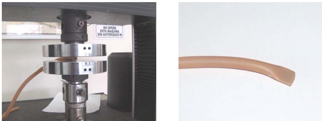
Figura 3.13 Pruebas de compresión para manguera de látex usando la máquina INSTRON 4469
