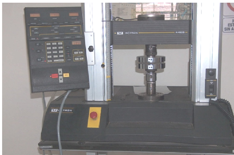
Figura 3.12 Máquina INSTRON 4469. Equipo para realizar ensayos destructivos en materiales a través de compresión y tensión.
