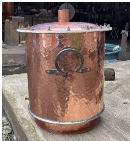
Figura 11. Montera adaptada para recirculación de agua y colocación de sensor.
