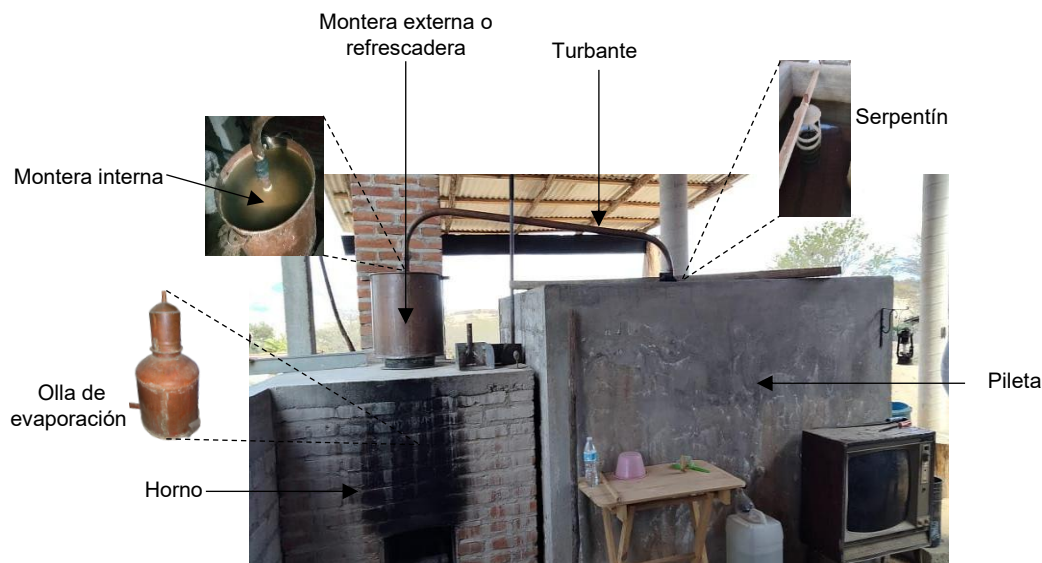
Figura 9. Esquema de los elementos que conforman el sistema de destilación artesanal de mezcal.
