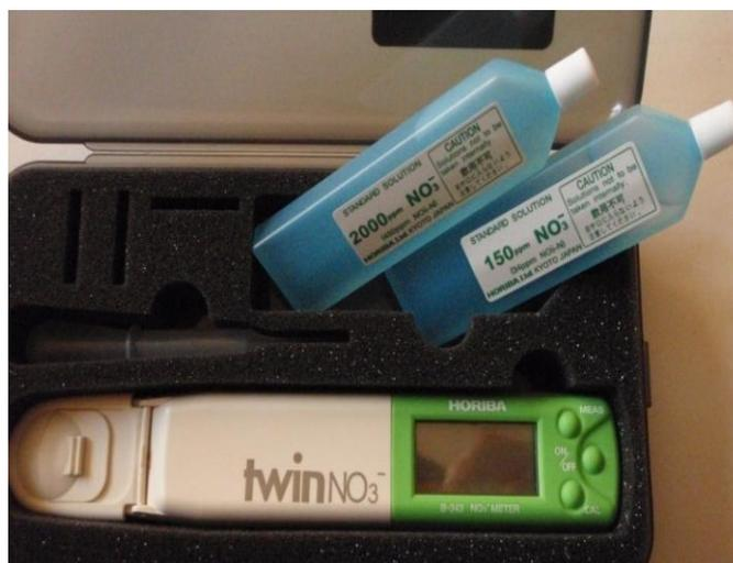
**Figura 4.2.** Medidor Cardy Twin para  $NO_3^-$ .
