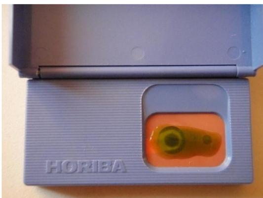
**Figura 4.3.** Cardy  $NO_3^-$  calibrado a 2000 ppm.
