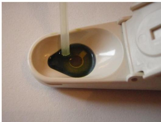
**Figura 4.4.** Cardy  $NO_3^-$  calibrado a 2000 ppm.
