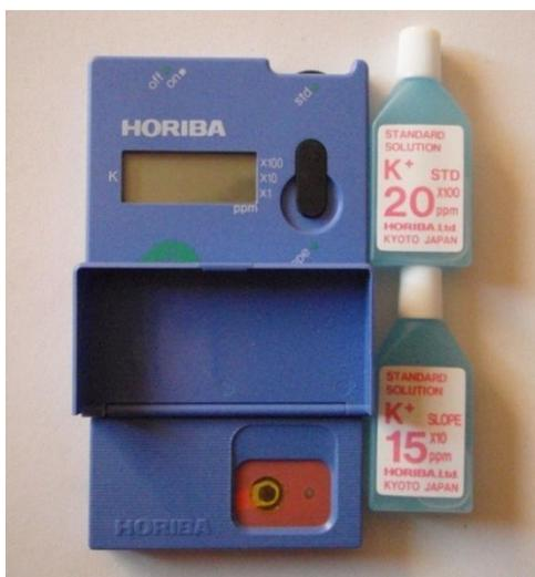
**Figura 4.1.** Medidor Cardy para  $K^+$ .
