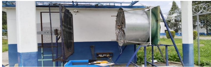
Figura 8 - Mediciones a la entrada del extractor en conjunto con un aerogenerador y una resistencia.
