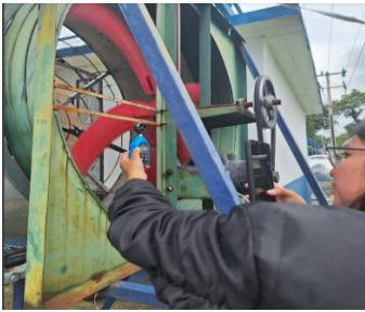
Figura 8 - Mediciones a la entrada del extractor en conjunto con un aerogenerador y una resistencia.
