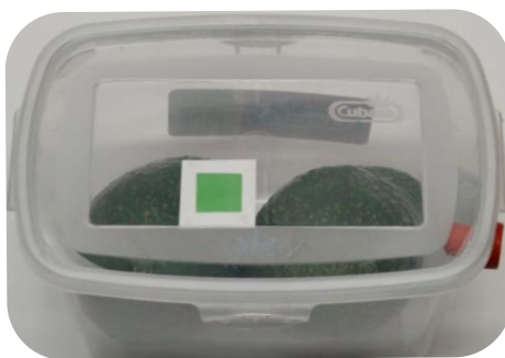
Figura 5. Almacenamiento de aguacate 'Hass' en envases de PET con la biopelícula indicadora sensible al pH.
