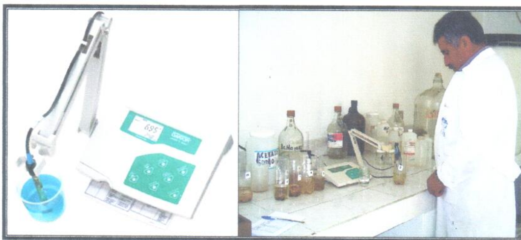
Fig. 22. Potenciómetro y medición del pH de la madera
