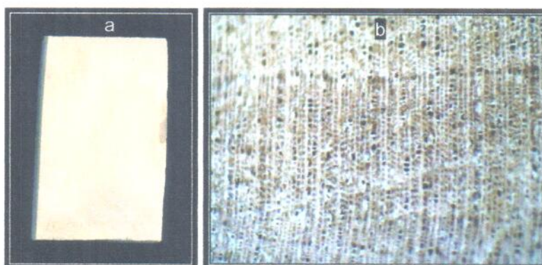
Fig. 28. Madera de reventón mostrando a) duramen y b) porosidad
