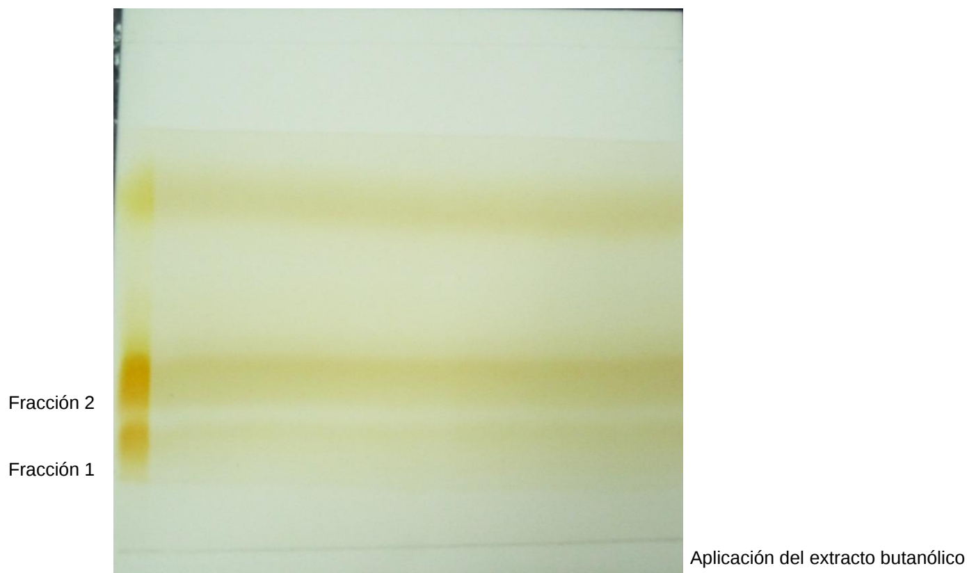
Figura 21. Placa cromatográfica preparativa ya revelada. Se observan dos manchas color amarillo a simple vista.
