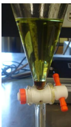
Figura 13. Partición del extracto metanólico con diclorometano: agua y, posteriormente, con butanol.
