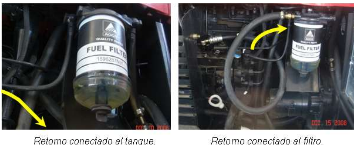
Figura 6.24 Conexión de la línea de retorno de la bomba de inyección al depósito.
