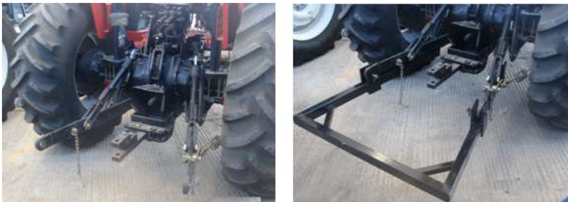
Figura 6.19 Estructura de ascenso-descenso montada en los brazos inferiores.
