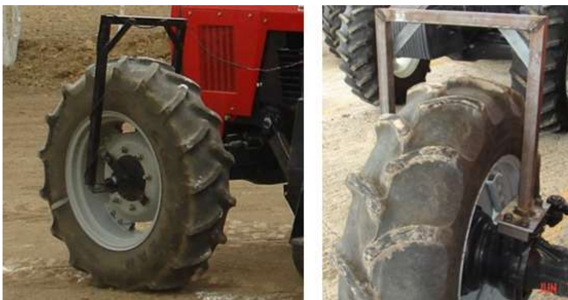
Figura 6.10 Estructura para fijar los encoders en las ruedas delanteras.
