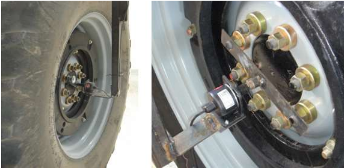
Figura 6.13 Acoplamiento del encoder y alineación con el eje de la rueda trasera.
