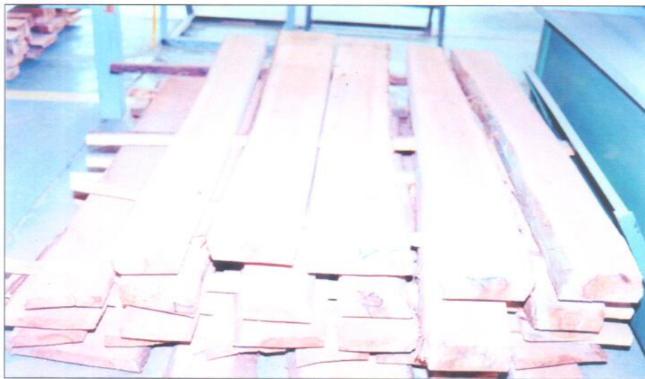
Figura 9. Tablones para la elaboración de probetas para ensayos mecánicos en condición seca
