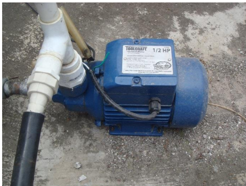
Figura 24. Bomba de ½ HP. Fuente: Autor, 2015.
