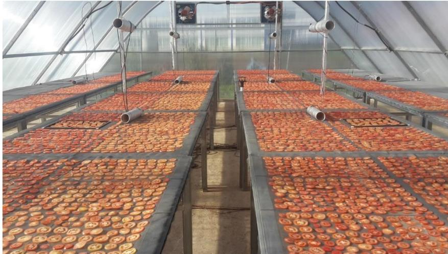
Figura 2. Deshidratado de jitomate en el sistema secador solar tipo invernadero ubicado en la Universidad Autónoma Chapingo, Chapingo, México.
