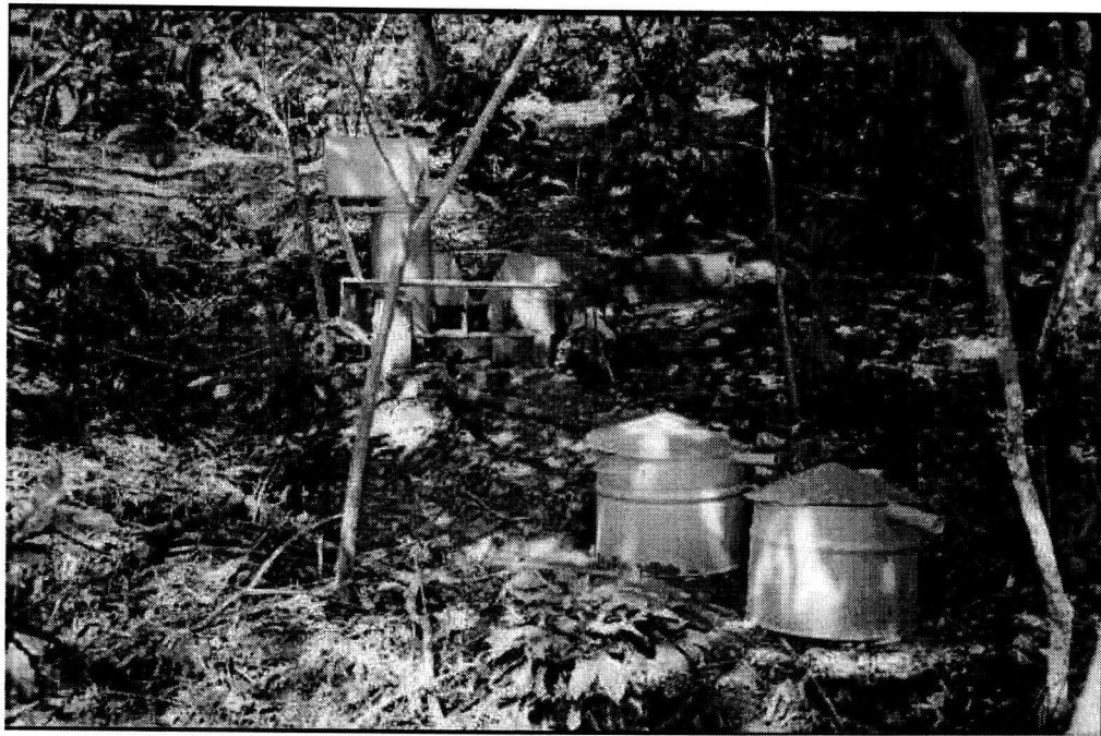
Figura 13. Equipo de muestreo de escurrimiento y pérdida de sedimentos colocado en cada uno de los tratamientos en El Coyol, Tlachichilco, Ver.
