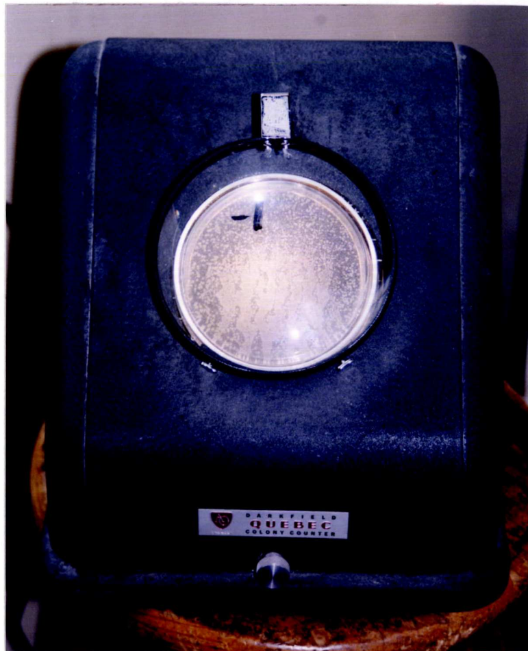
Figura 7. Contador de bacterias mesófilas tipo Quebec.
