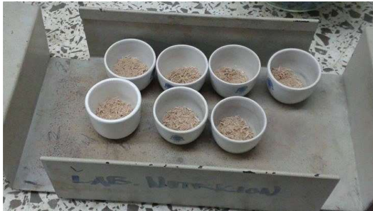
Figura 4. Crisoles con astilla para la prueba de cenizas (Fuente: archivo fotográfico Imelda Vargas).
