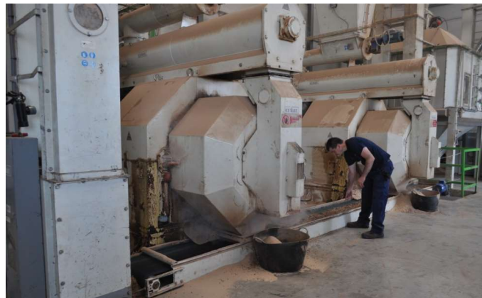
Figura 27. Peletizadora de matriz anular cilíndrica con capacidad de 2 t/h. Fuente: Archivo fotográfico, Imelda Vargas.
