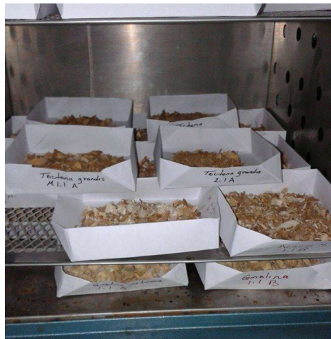
Figura 2. Astilla de madera en la estufa de secado
