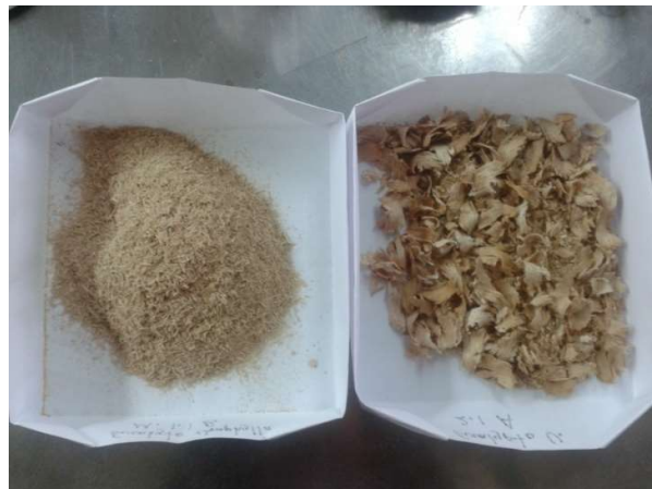
Fig. 1: Astilla molida vs astilla sin moler para la prueba de contenido de humedad.
