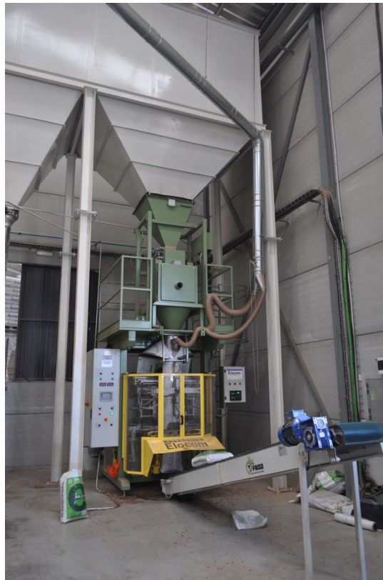
Figura 30. Dosificadora de pellet para su ensacado.
