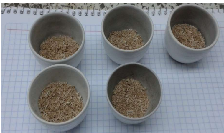
Fig. 3: Crisoles con la muestra de astilla para la prueba de cenizas.
