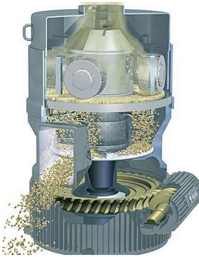
Figura 26. Esquema de peletizadora de matriz plana. Fuente: Amandus Kahl Ibérica S.L, maquinaria.
