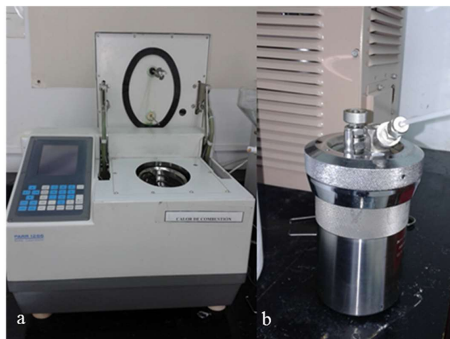
Fig. 2: a) Calorímetro usado para determinar el poder de combustión y b) bomba calorimétrica donde se colocó la muestra de astilla para su combustión.
