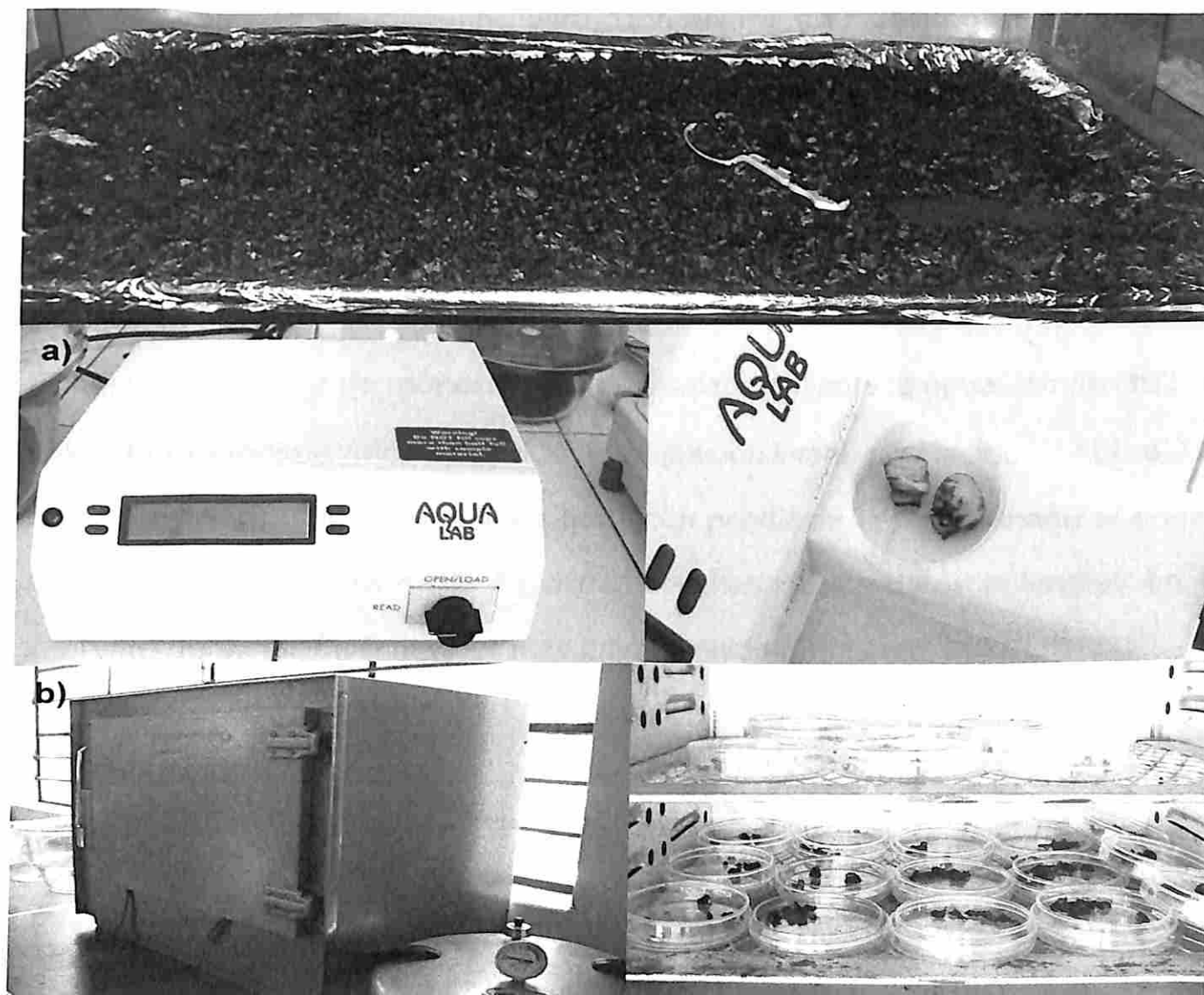
Figura 20. Obtención de isotermas de desorción a 70 \pm 2^{\circ}\text{C} . a) Medición de la actividad de agua. b) Determinación de humedad en estufa de secado.
