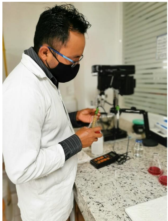
Figura 4. Lectura de Sólidos solubles totales con un refractómetro (izquierda) y pH con un potenciómetro (derecha).
