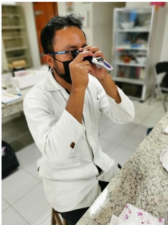
Figura 4. Lectura de Sólidos solubles totales con un refractómetro (izquierda) y pH con un potenciómetro (derecha).
