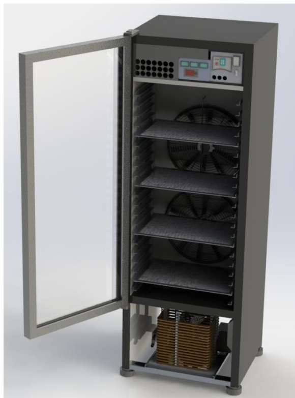
Figura 54 Modelo tridimensional del deshidratador asistido por bomba de calor
