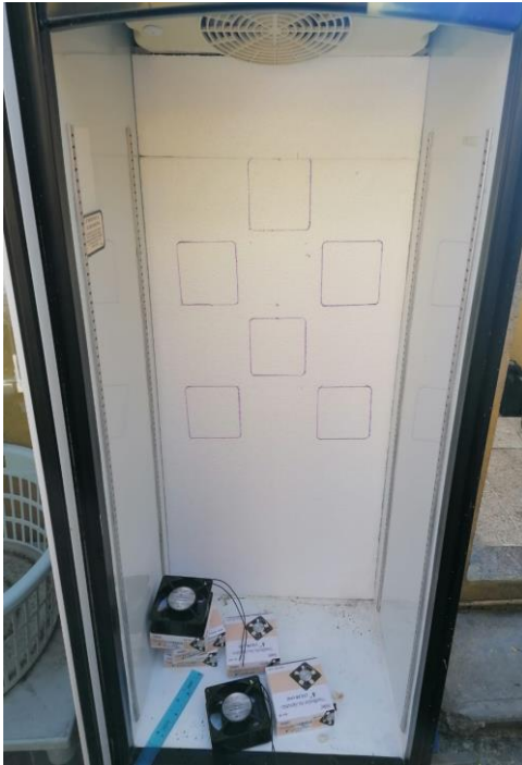
Figura 31 Instalación de ventiladores
