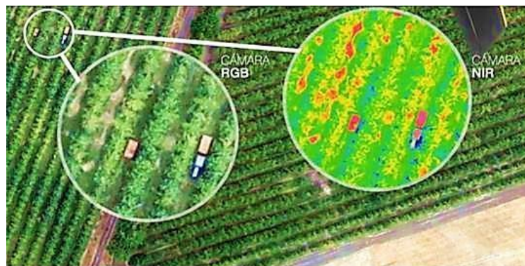
Figura 2.2: Imágenes según tipos de cámara y espectros (RGB y NIR). Recuperado de Pino (2019).
